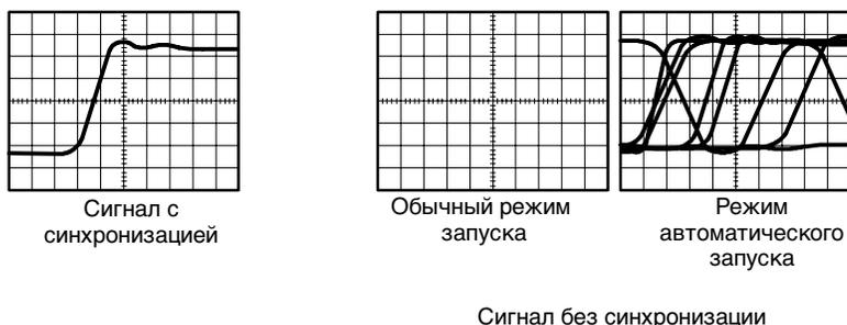
**Рис. 3-18: Синхронизированные и несинхронизированные сигналы**
