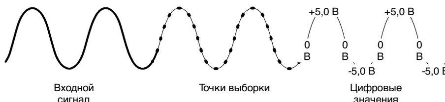
Рис. 3-10: Цифровая регистрация — выборка и оцифровка
